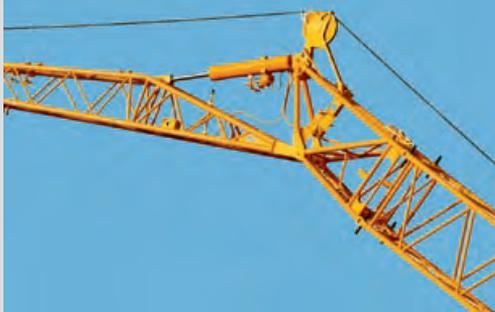
Tamburo avvolgitubo flessibile per cilindro idraulico
