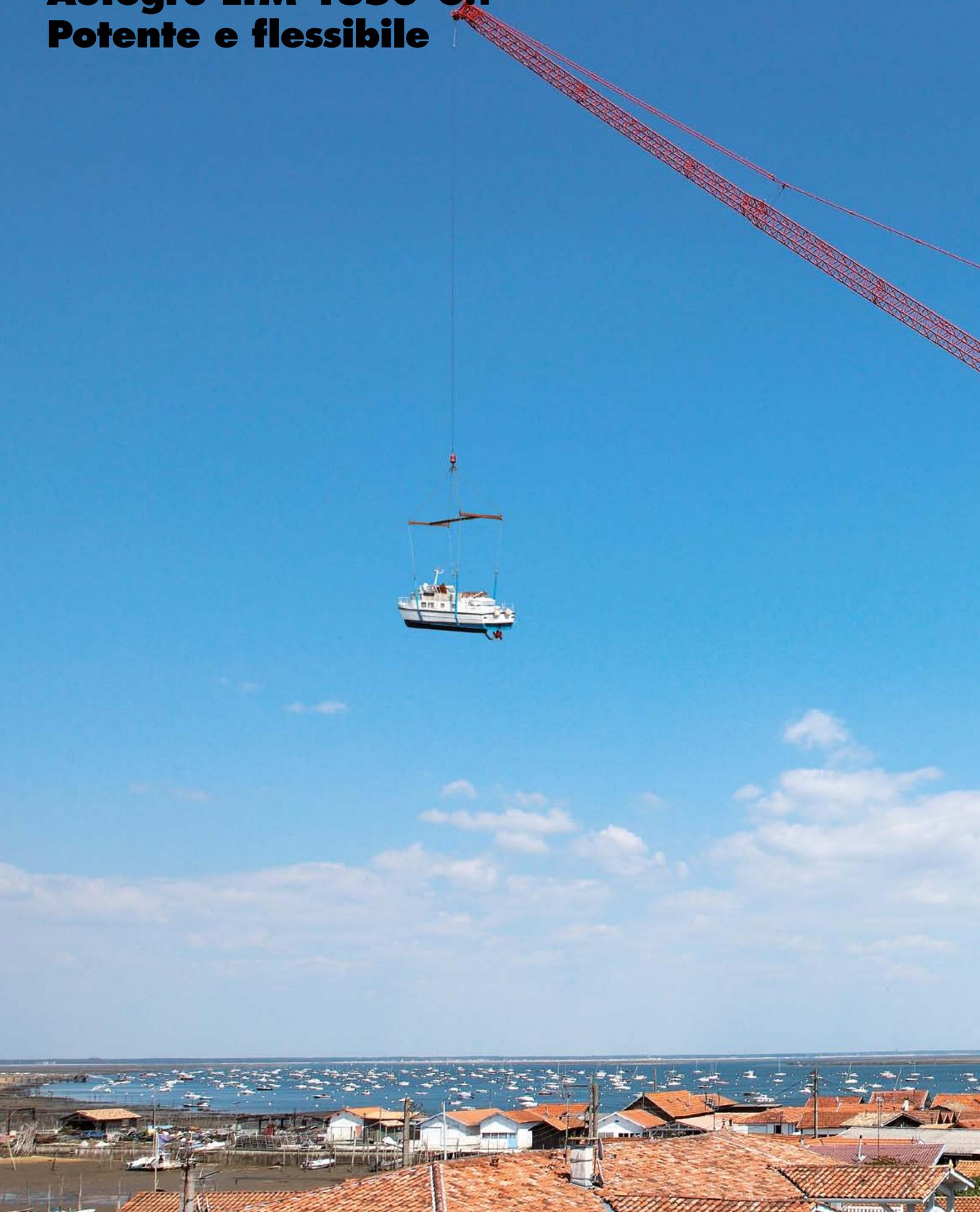
Un braccio telescopico lungo, le elevate capacità di portata, una straordinaria manovrabilità, i dispositivi di sicurezza e un equipaggiamento confortevole caratterizzano l'autogrù Liebherr LTM 1350-6.1. Questo modello da 350 tonnellate offre tecnologia all'avanguardia sempre più utile nell'impiego quotidiano.
